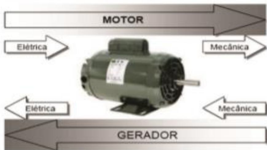
Fig. 1.1 – Conversão eletromecânica de energia.
